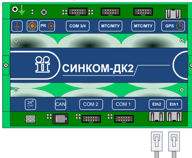
Рис. 5. Подключение каналов Ethernet к контроллеру «Синком-ДК2»
